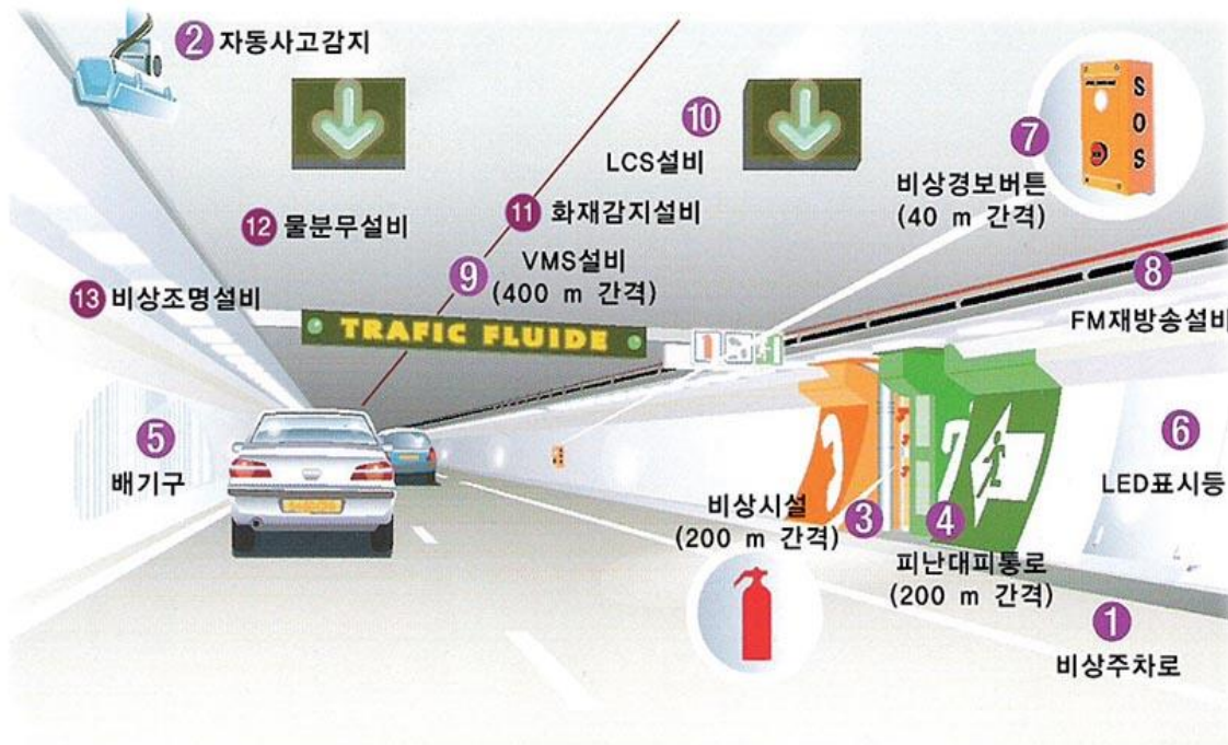
[기존 도로터널 TTMS 시스템 배치도]
